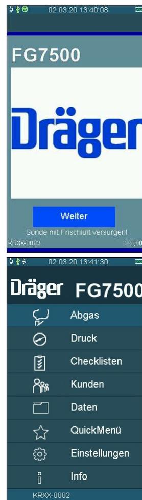
In den ersten 30 Sekunden führt das Gerät eine Stabilisierung und einen Systemcheck durch. Das wird durch den Fortschrittsbalken unter der Uhrzeitanzeige und durch ein grünes Quadrat in der Kopfzeile dargestellt. In dieser Zeit kann keine Messfunktion gestartet werden. Verwaltungsfunktionen können in dieser Zeit bereits genutzt werden. Ist eine Regelwartung durchzuführen, erinnert das Gerät ab einem Monat vor Fälligkeit an den Wartungstermin.
