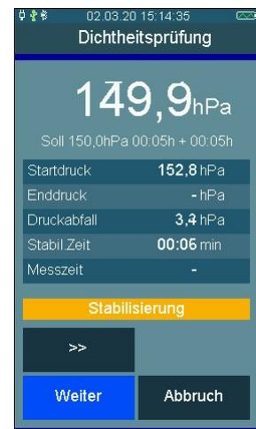
**Messung:** In der Messzeit werden der Druckverlauf, sowie Start-, End- und Differenzdruck aufgezeichnet. Die ausgewählte Messzeit kann durch „Beenden“ verkürzt werden.
