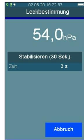
Der aktuelle Druck, der Druck zu Beginn der Messung, die bisher verstrichene Messzeit, der Druckabfall und die derzeit ermittelte Leckrate werden angezeigt.
