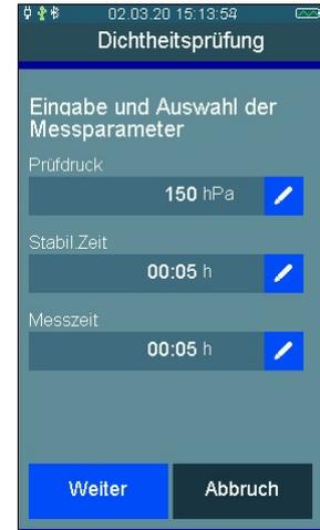
„Weiter“ startet das Messprogramm. Während der Messung kann mit „>>/<<“ jederzeit zwischen Tabellen- und Diagrammdarstellung umgeschaltet werden.
