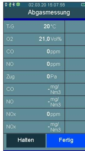
Bei der Anzeige in mg/Nm<sup>3</sup>, mg/MJ und mg/kWh werden vor der Messung der Brennstoff und der O<sub>2</sub>-Bezugswert ausgewählt. Bei der Anwahl eines Brennstoffs ist der standardmäßige O<sub>2</sub>-Bezugswert voreingestellt.
