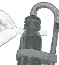
C Realizar 10 recorridos de aspiración completos, recorrer lenta y uniformemente 8aspirar), demorar un poco en el tope (Compensación de presión), después regresar rápidamente. De acuerdo a la norma se aspirarán 1,63+/-0,07dm<sup>3</sup> de gas residual a través del filtro.
