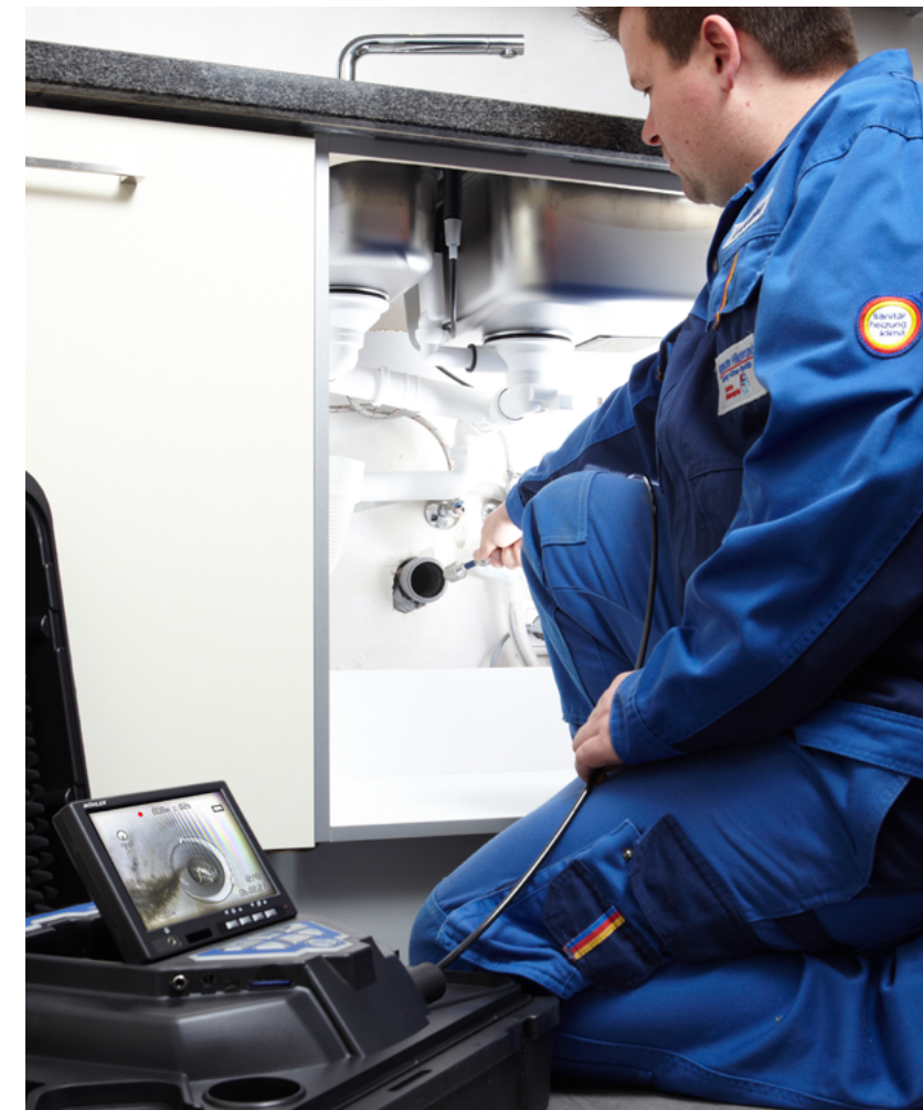
Bis 3 bar wasserdichter, robuster Farbkamerakopf mit Ø 26 mm lässt sich durch mehrere 87°-Bögen in Rohrleitungen von Ø 40 mm schieben.
